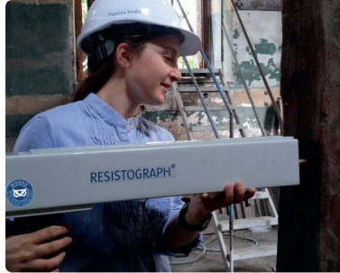
a) Resistograf uygulaması
