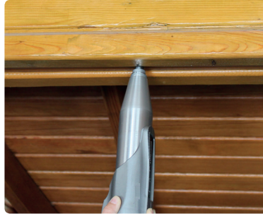
b) Ahşapta test çekici uygulaması
