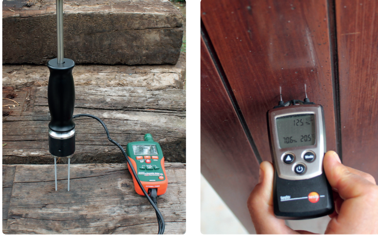
Şekil 3.12 Ahşapta Nem ölçümü (N. P. Seçkin) GPR (yeraltı radarı)
