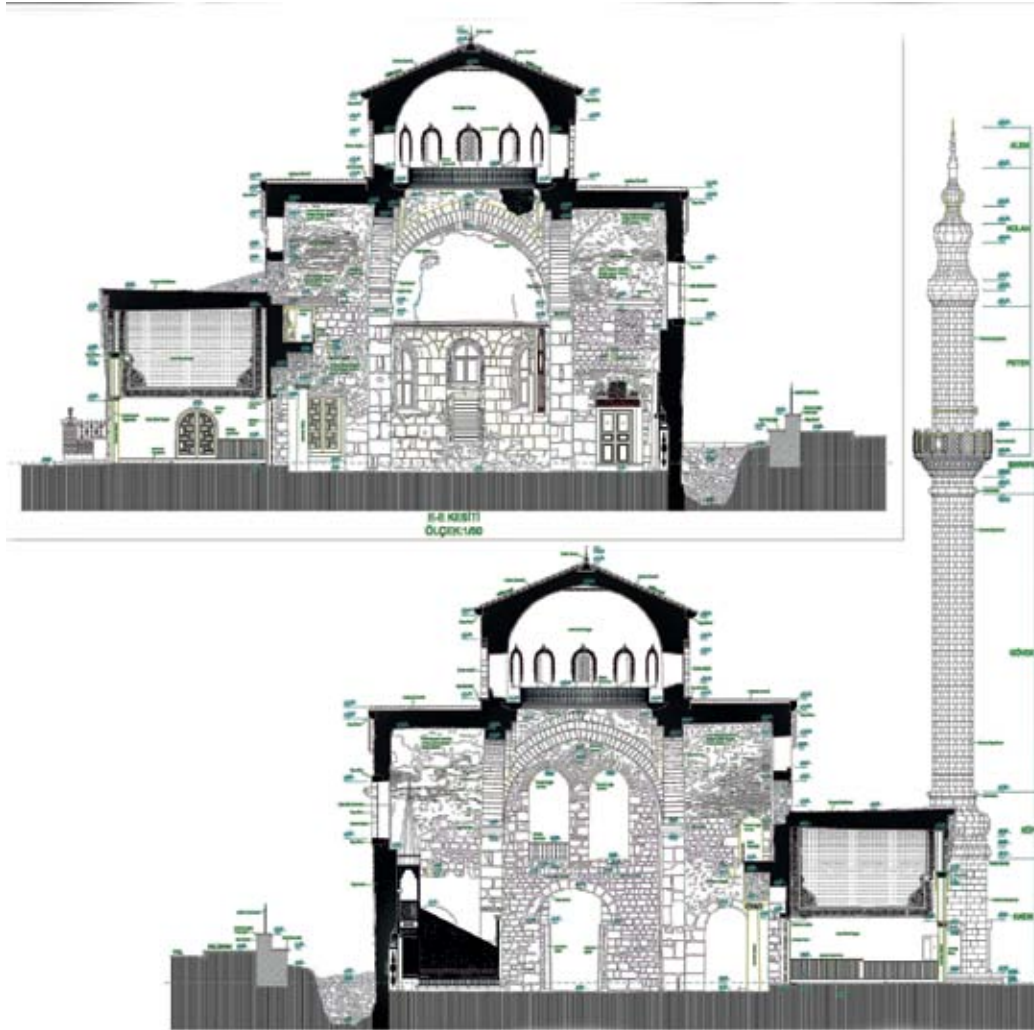
Şekil 12. Yapının kuzey revağının metotokhion ile birlikte kesiti.
